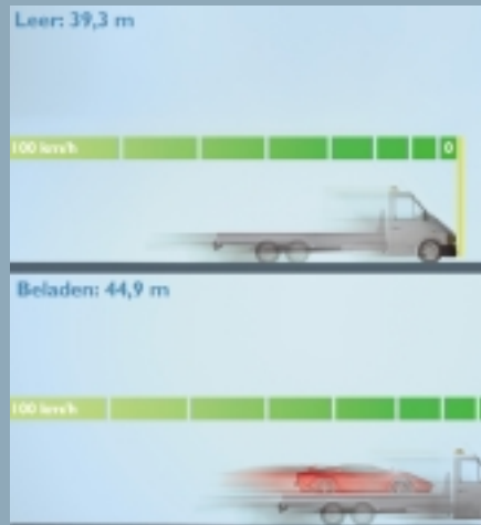
Bestwerte in der Verzögerung durch Hochleistungsbremsen. Im beladenen Zustand bei Testfahrten mit 4.800 kg Gesamtgewicht.
