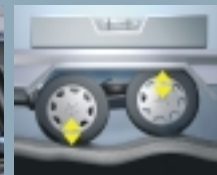
Gleiten statt aufschaukeln durch 100 % Lastausgleich zwischen den Achsen.
