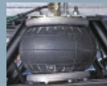
Intercity-Feeling durch luftgefederte Pendel-Doppelachse.
