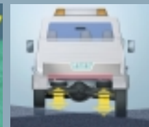
Wankausgleich durch progressive Luftfederung.
