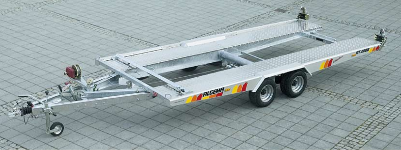
Anhänger in Grundausstattung mit mechanischer Winde.
