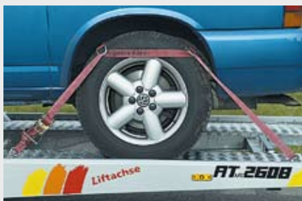
Ladungssicherung leicht gemacht: Zwei Haken werden in versenkte Ösen eingeklinkt und gespannt. Fertig!
